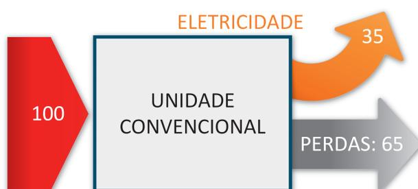
Figura 5.1- Rendimento típico de uma unidade convencional de geração de energia elétrica
