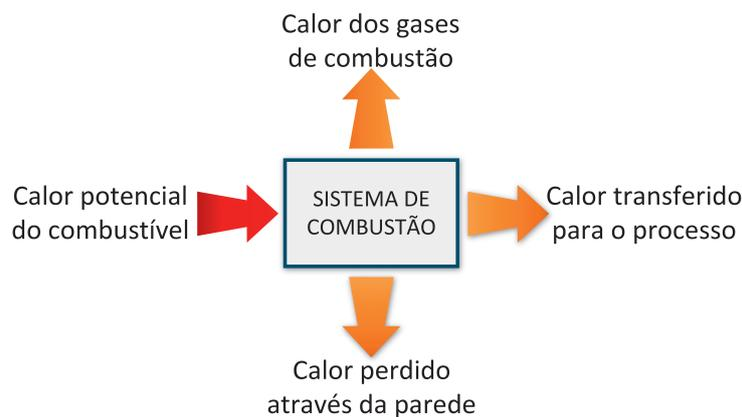
Figura 4.2 - Balanço de conservação de energia a um sistema de combustão genérico
